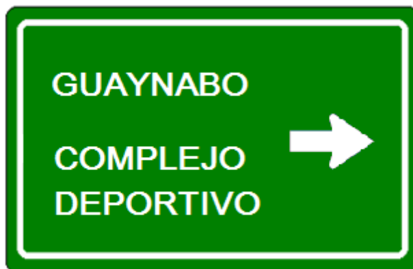
Figura 27. Ejemplo de rótulo para un complejo deportivo con combinación de destinos en una carretera convencional.
