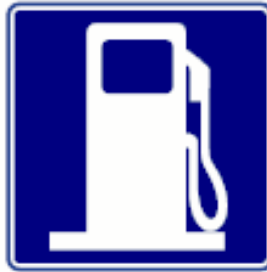
Figura 19. Rótulo D9-7 para el servicio de gasolina.
